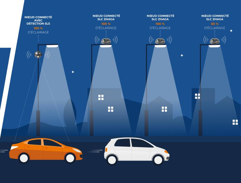
Grâce aux capteurs (PIR et radar) et à l'intelligence embarquée dans le nœud, le SLS permet d'adapter l'éclairage en temps réel en fonction de la présence et de la vitesse des piétons, cyclistes et véhicules.
