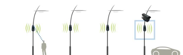
**Dispositif qui permet de mailler divers métiers de la ville avec l'écosystème de détection SensyCity afin d'ajuster et d'optimiser l'éclairage public en fonction d'informations diverses.**
