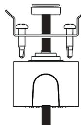
**6. Dévisser les 4 vis du boîtier-prise, insérer la prise et remettre les 4 vis en place :**
