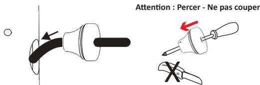
**3. Couper le passe-fil (situé à l'arrière du boîtier-prise) au bon diamètre :**
