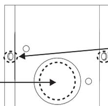
Pré-perçage du mât pour fixer le support (vis 4.8x25) :  $\varnothing 4.3\text{mm}$  (sauf si fixation par feuillard)
