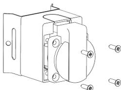
**7. Fixer le Kit Miniprise sur le mât à l'aide des 2 vis 4.8x25 ou du feuillard :**
